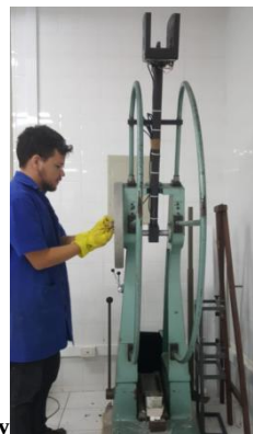
Figura 4 – Ensaio de tenacidade com o Pêndulo de Charpy
