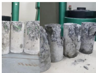
Figura 6 – Corpos de prova cilíndricos após o ensaio de compressão uniaxial
