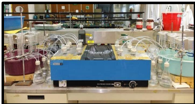
Fotografía 4. Sistema de reactores anaerobios.
