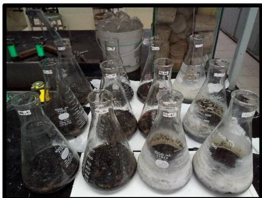
Fotografía 3. Reactores preparados con mezcla FO+inóculo+agroplástico.
