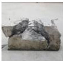
Figura 5 – Corpo de prova de concreto (CFC) após o ensaio de impacto
