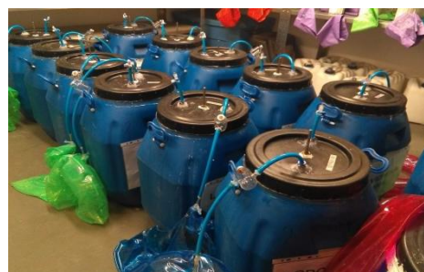
Figura 3. Reactores usados en la digestión
