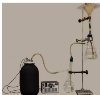
Figura 4. Diseño experimental para extraer alquitrán
