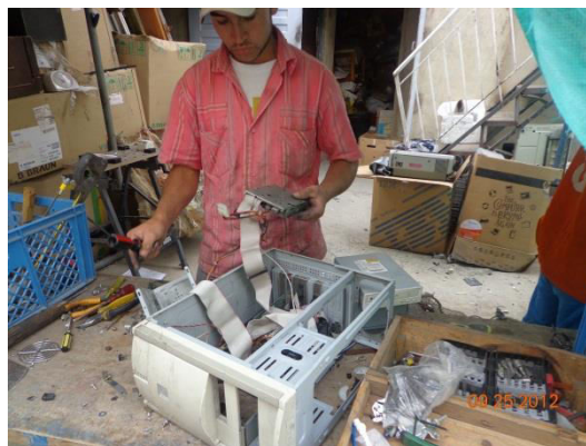
Imagen 1 y 2. Detalle del trabajo de los operarios de la ARB, mientras realizan el despiece de un RAEE.
