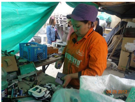
Imagen 1 y 2. Detalle del trabajo de los operarios de la ARB, mientras realizan el despiece de un RAEE.
